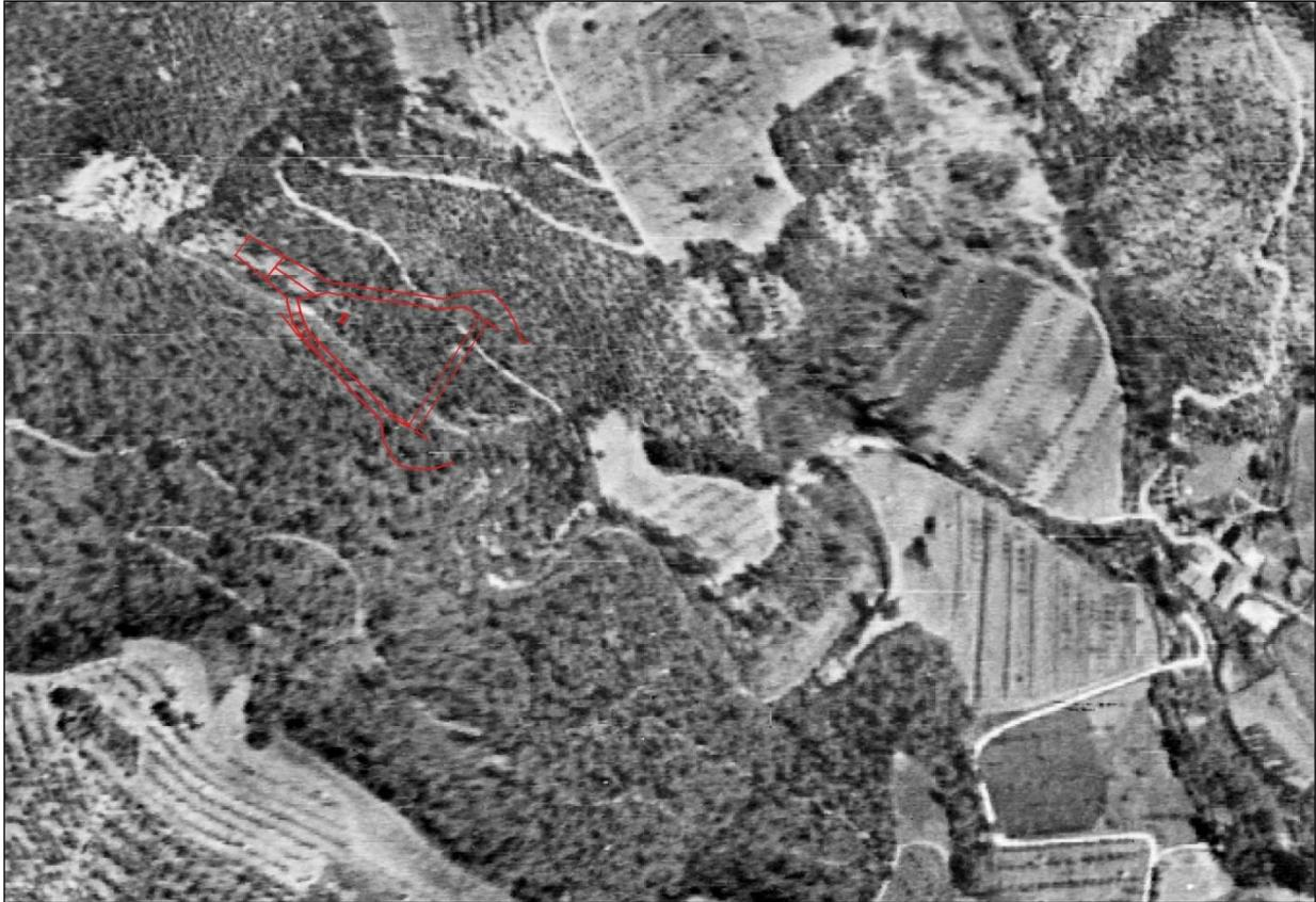
Figura 3-1 – Ortofotografia 1954 (Volo GAI) dello stato dei luoghi prima della costruzione della diga Drove di Cepparello (base RT-OFC 10k54). La sagoma attuale della diga è rappresentata dalle linee di colore rosso.
