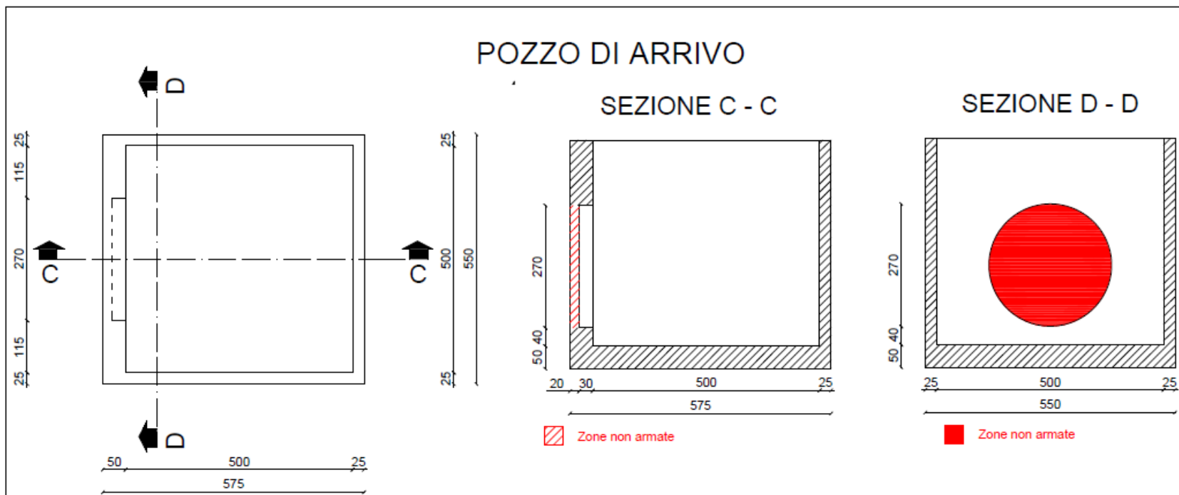
Figura 4-2 – Pozzo di arrivo.
