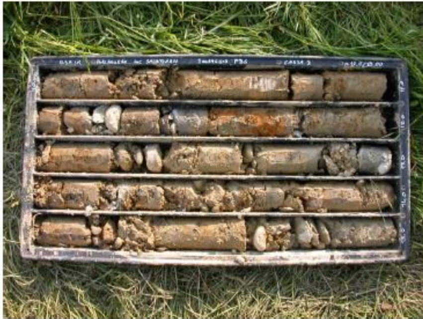
Foto 3: Sondaggio P34 - cassa 3 - da 10.00 m a 15.00 m.
