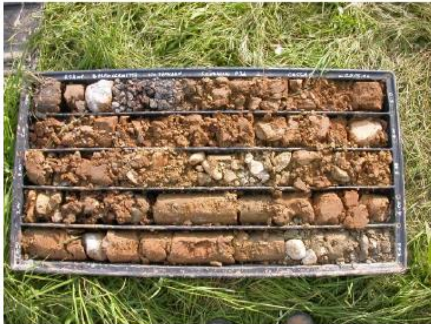
Foto 1: Sondaggio P34 - cassa 1 - da 0.00 m a 5.00 m.
