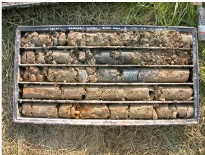
Foto 2: Sondaggio P34 - cassa 2 - da 5.00 m a 10.00 m.
