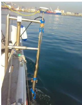
sistema gps con trasduttore multibeam a palo
