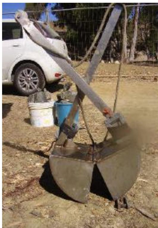
Il contenuto della benna veniva riversato su grossi setacci, di cui il più sottile con maglie da un millimetro, e sottoposto a lavaggio con getti d'acqua di mare a pressione ridotta. Il materiale così selezionato veniva quindi conservato con una soluzione al 5% di formaldeide tamponata con carbonato di calcio anidro, entro appositi contenitori antiacido debitamente etichettati.
