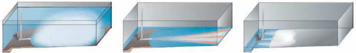
Figura 2 - le 3 fasi di pulizia: bulk-flow – flussaggio – flussaggio finale.
