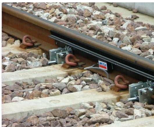
Lubrificatore P.A.L. Italia (Foto: P.A.L. Italia; 2012)
