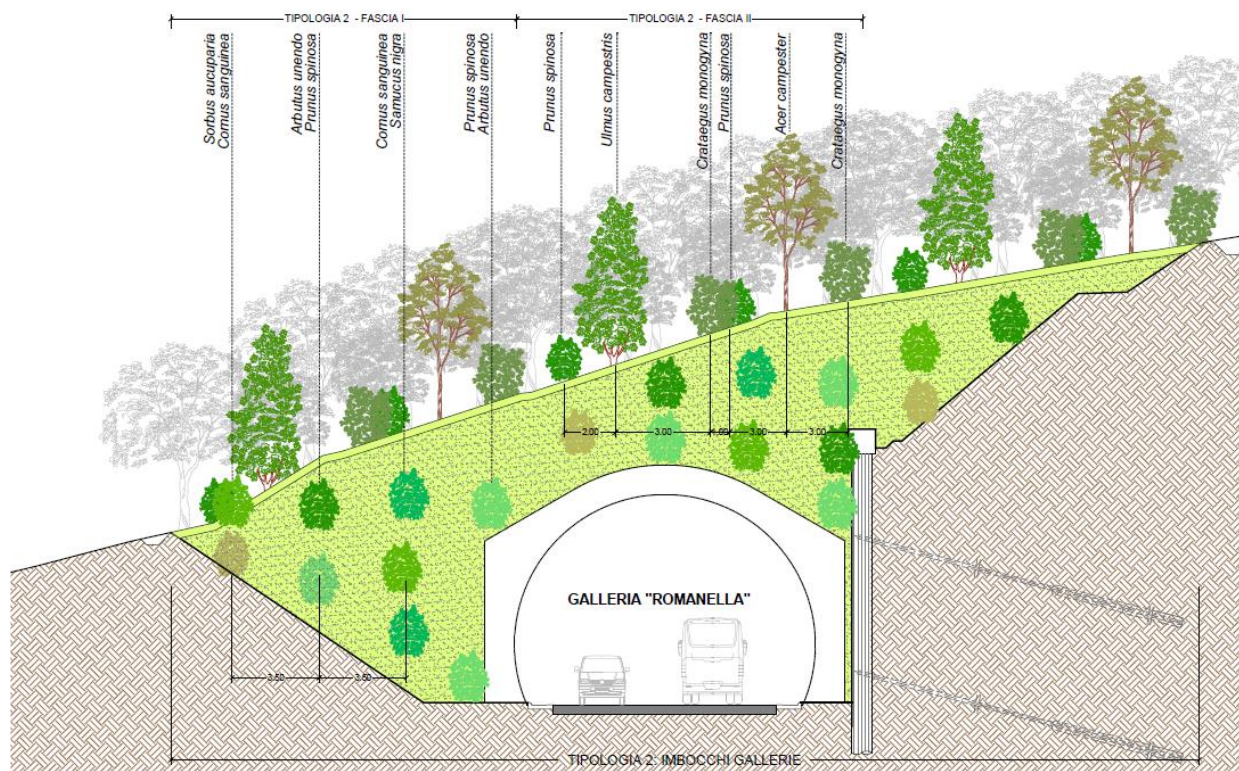
Figura 9 - Sezione trasversale Galleria artificiale Romanella.
