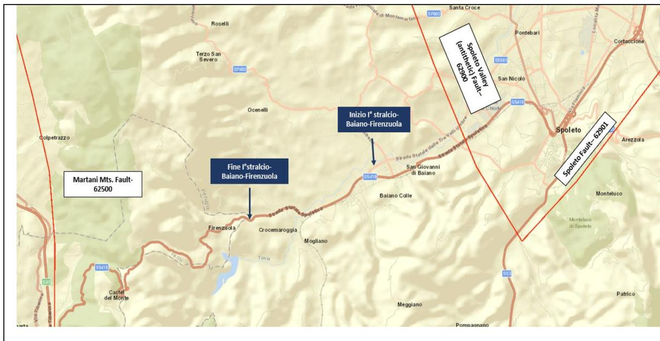
Figura 5- Mappa delle faglie capaci estratta dal "Catalogo delle Faglie Capaci (ITHACA-ISPRA)" con in evidenza la zona di inizio e fine stralcio di progetto.
