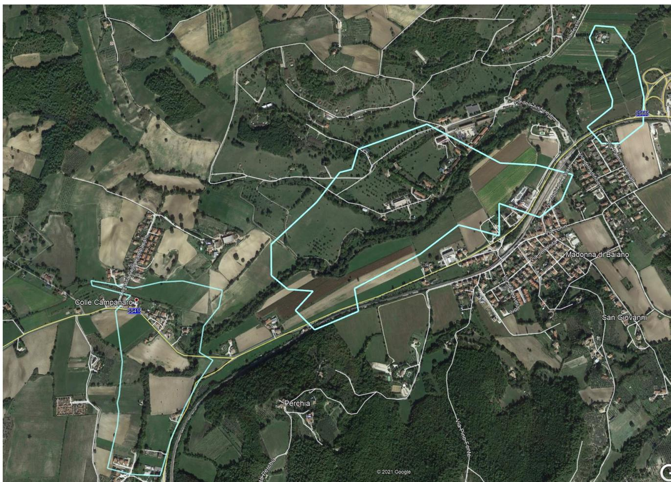
Nella figura riportata in calce si evidenziano le aree in cui la presenza dell'opera in progetto determinerà tiranti idrici superiori allo stato ante Operam per la rottura dell'argine.
