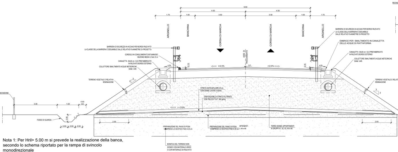
Nota 1: Per Hrl > 5.00 m si prevede la realizzazione della banca, secondo lo schema riportato per la rampa di svincolo monodirezionale
