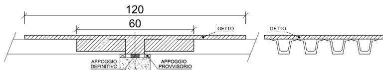
3 - POST-TENSIONE DELLA SOLETTA E DEL TRAVERSO e RIMOZIONE DEGLI APPOGGI PROVVISORI
