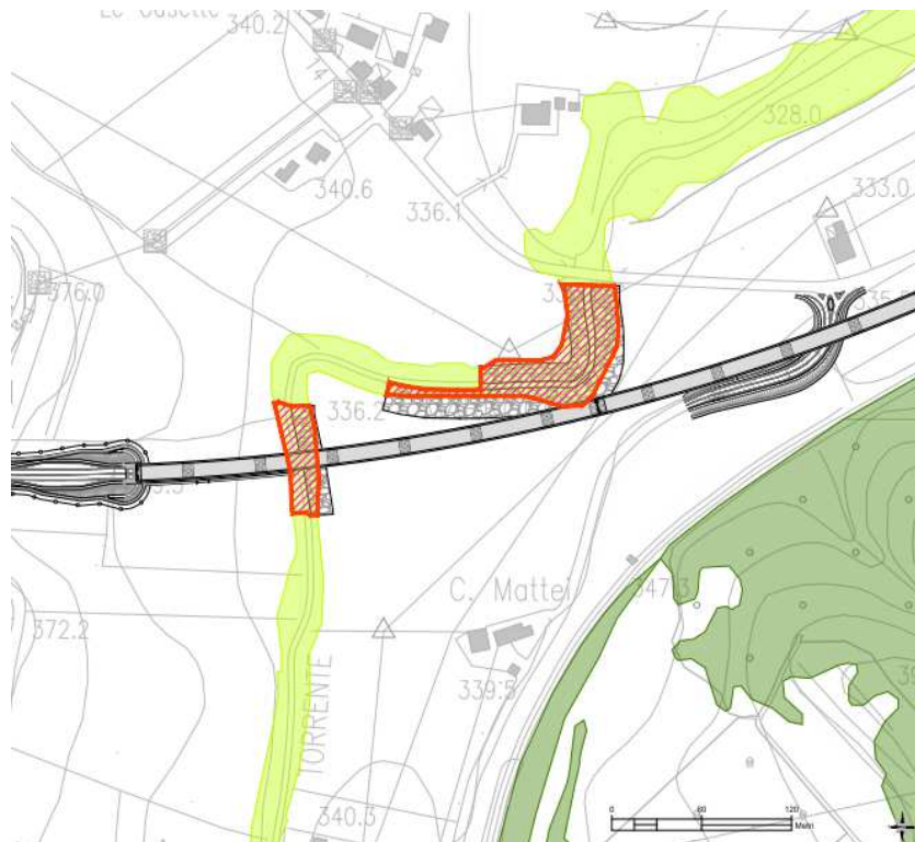
Figura 14. Taglio alberi in corrispondenza dell'attraversamento del torrente Marroggia (5.678 mq).
