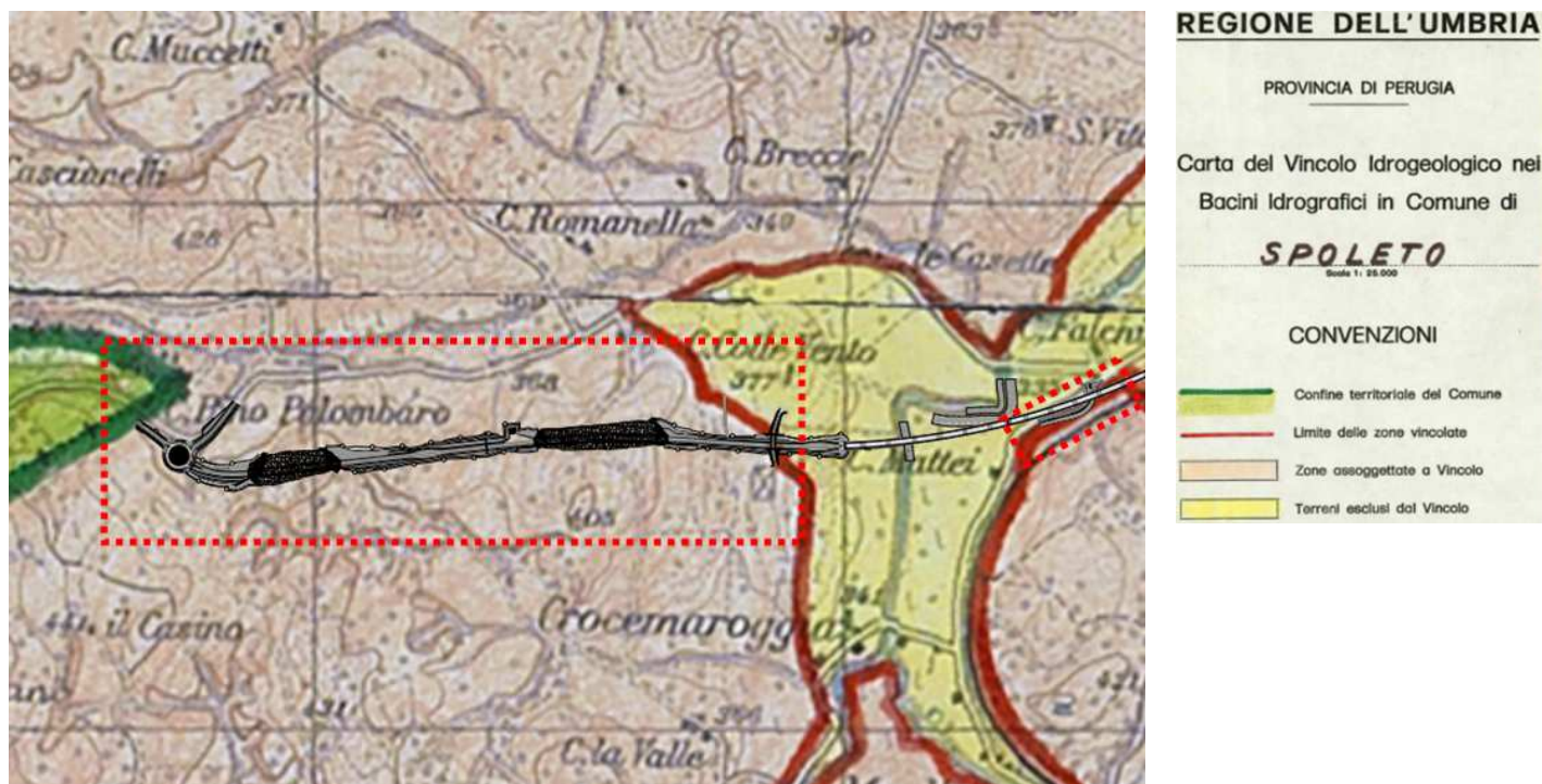
Figura 16. Estratto della cartografia del vincolo idrogeologico (fonte: https://siat.regione.umbria.it/vincoloidrogeologico/ ). Porzioni di tracciato ricadenti in aree sottoposte a Vincolo Idrogeologico R.D. 3267/23.
