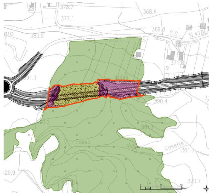
Figura 13. Taglio alberi in corrispondenza della Galleria Artificiale Romanella (13.913 mq). Previsto parziale rimboscimento (6.333 mq)
