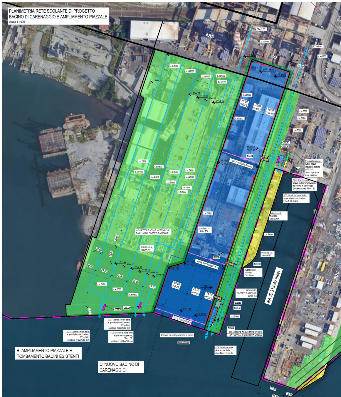
Figura 7 – Reti scolanti di progetto-Intervento B
