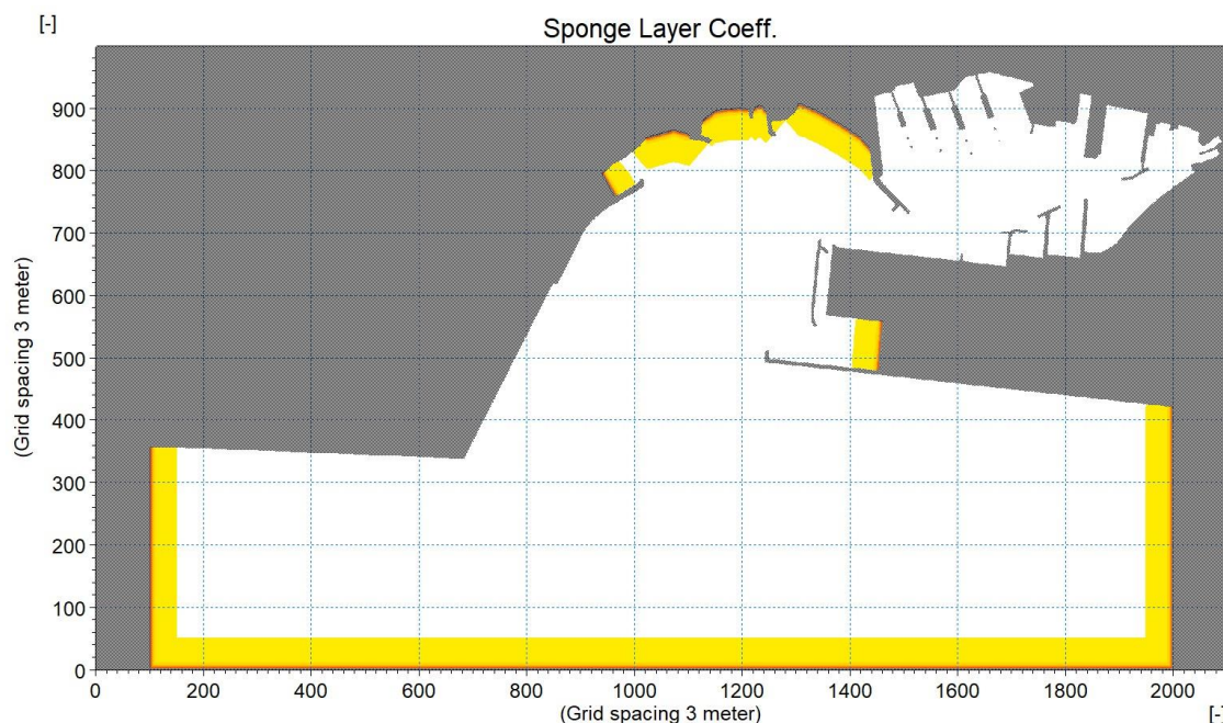
Figura 7.4 – Localizzazione dello strato assorbente (tonalità di giallo e rosso) in riferimento alla griglia di calcolo
