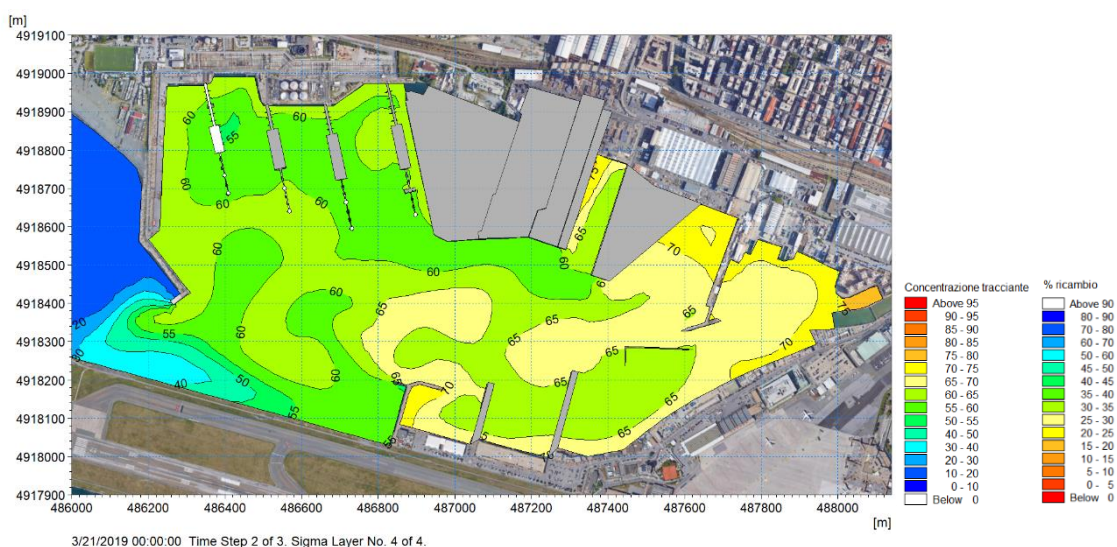
Figura 6-11 Concentrazione di tracciante (e percentuale di volume ricambiato) in superficie dopo 20 giorni durante il mese di Marzo 2019
