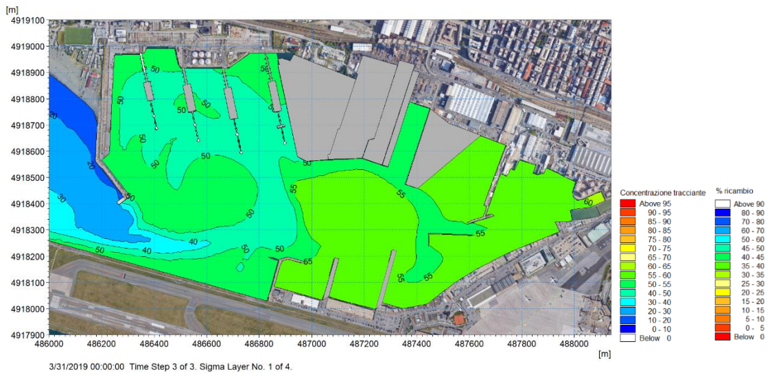
Figura 6-14 Concentrazione di traccianti (e percentuale di volume ricambiato) al fondo dopo 30 giorni durante il mese di Marzo 2019
