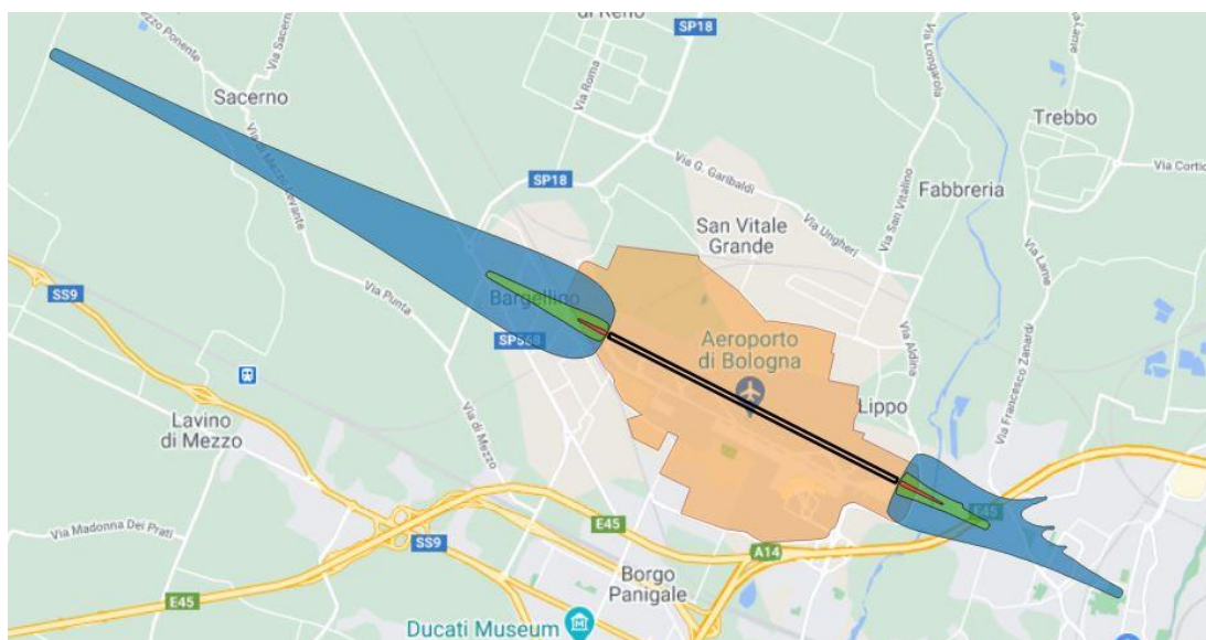
Rappresentazione curve isorischio risultanti dall'analisi dell'incidentalità [fonte: Studio per la valutazione del rischio individuale contro terzi, aprile 2012]
