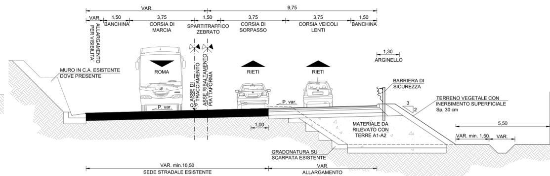
IN RILEVATO CON OPERA DI SOTTOSCARPA
