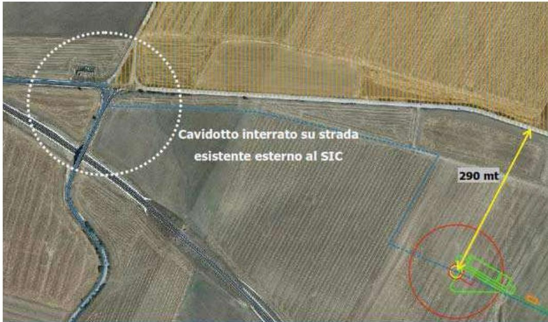
**Figura-2: Particolare del tracciato del cavidotto e dalla WTG n.9 in relazione al SIC**
