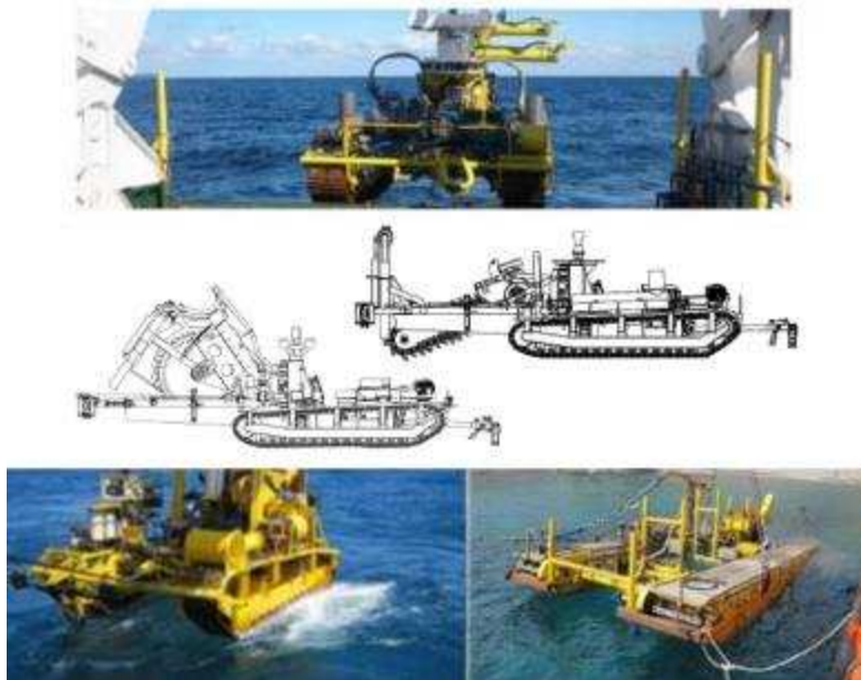
Figura 6.3.3: Macchine per il trenching convenzionale
