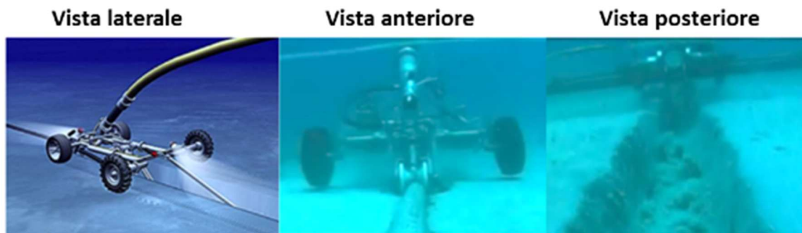
Figura 6.3.1: Macchine per jetting autopropulse
