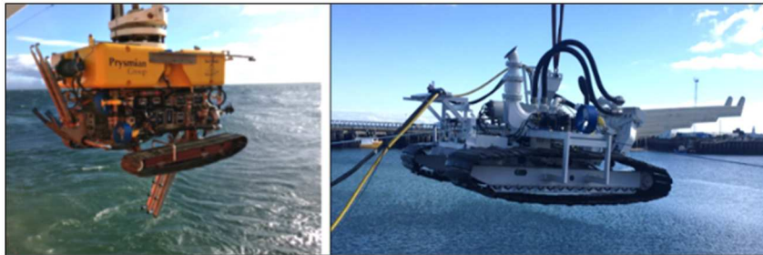
Figura 6.3.2: Macchine per jetting autopropulse su cingolato
