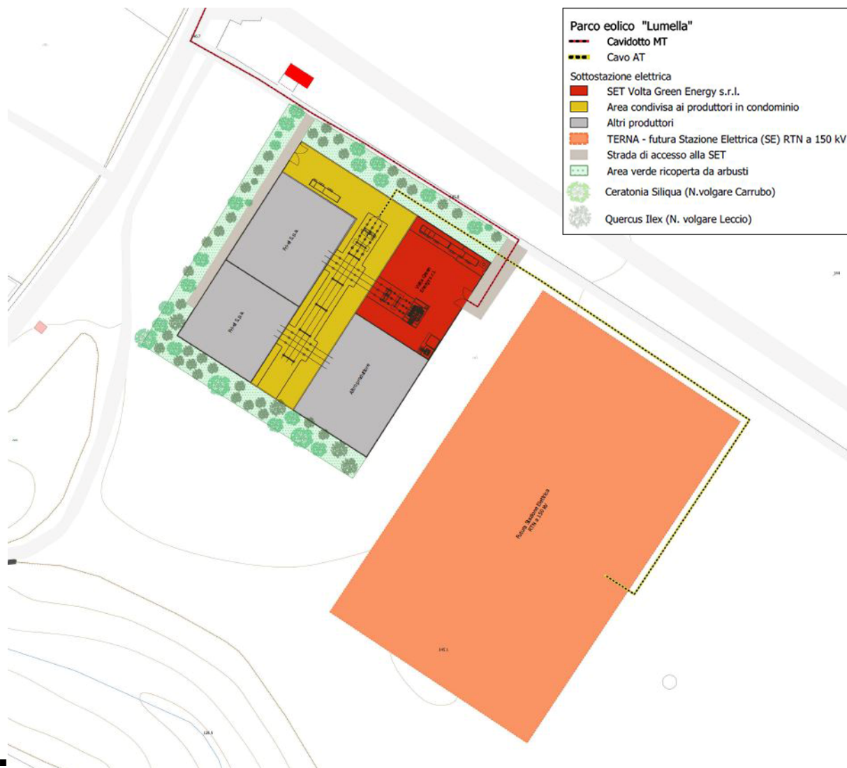
Figura 1: Stralcio corografia con indicazione della posizione della stazione utente rispetto alla stazione Terna di smistamento a 150 kV.
