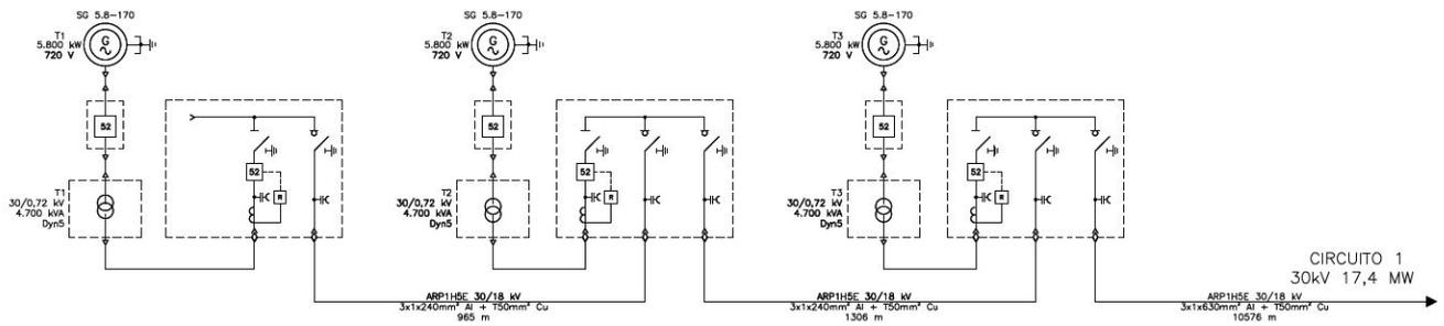
Figura 1: schema elettrico parco eolico (circuito 1)
