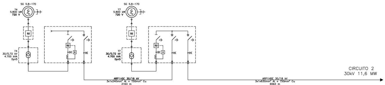
Figura 2: schema elettrico parco eolico (circuito 2)
