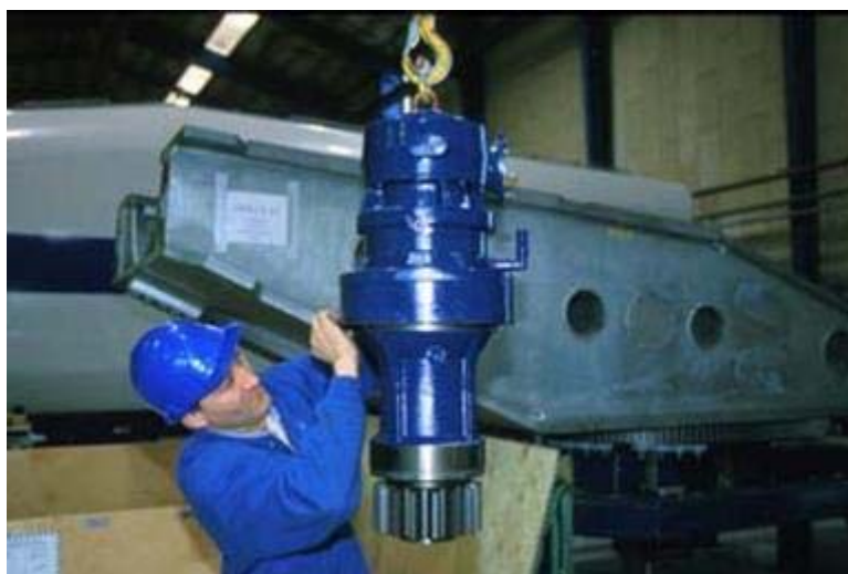
Figura 6: motori di giro e riduttori
