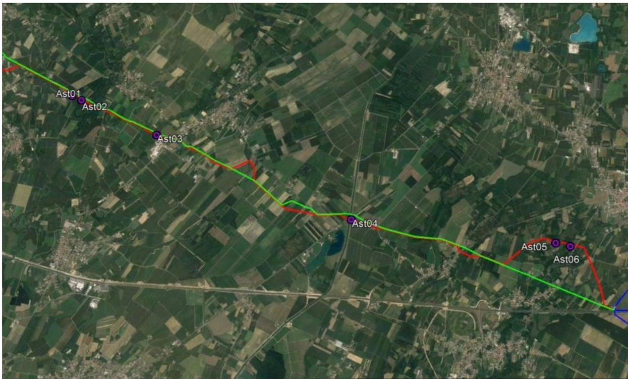
Fig. 4.A Punti di monitoraggio ambiente idrico - acque sotterranee (linea rossa tracciato di progetto; linea verde tracciato da porre fuori servizio)
