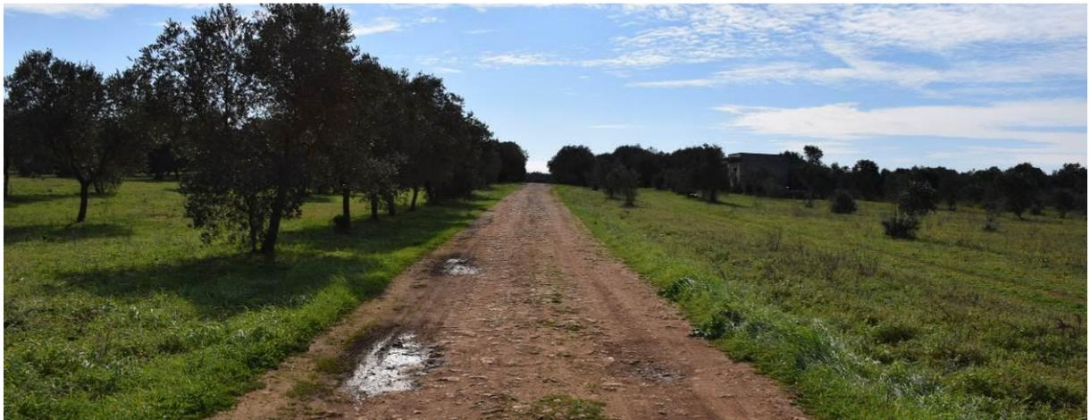
**Figura 16 – Strada locale di accesso all'aerogeneratore A05.** La strada ha larghezza adeguata e necessita esclusivamente di interventi di livellamento del piano viario atti a eliminare buche e sconnessioni.
