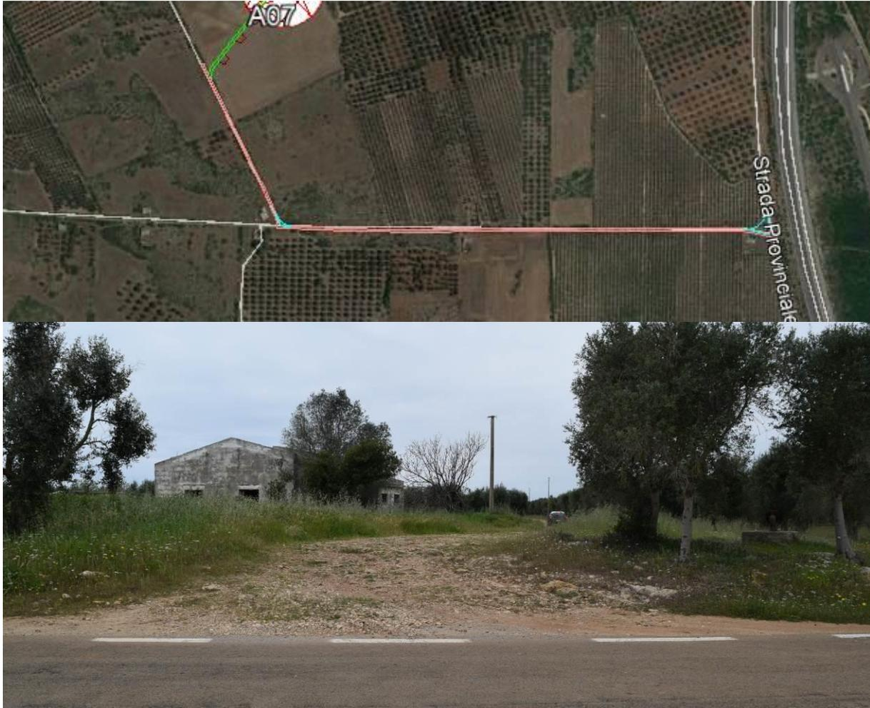
**Figura 16: Imbocco dalla SP219 della strada di accesso al sito di ubicazione dell'aerogeneratore A07 che necessita di allargamento temporaneo.**
