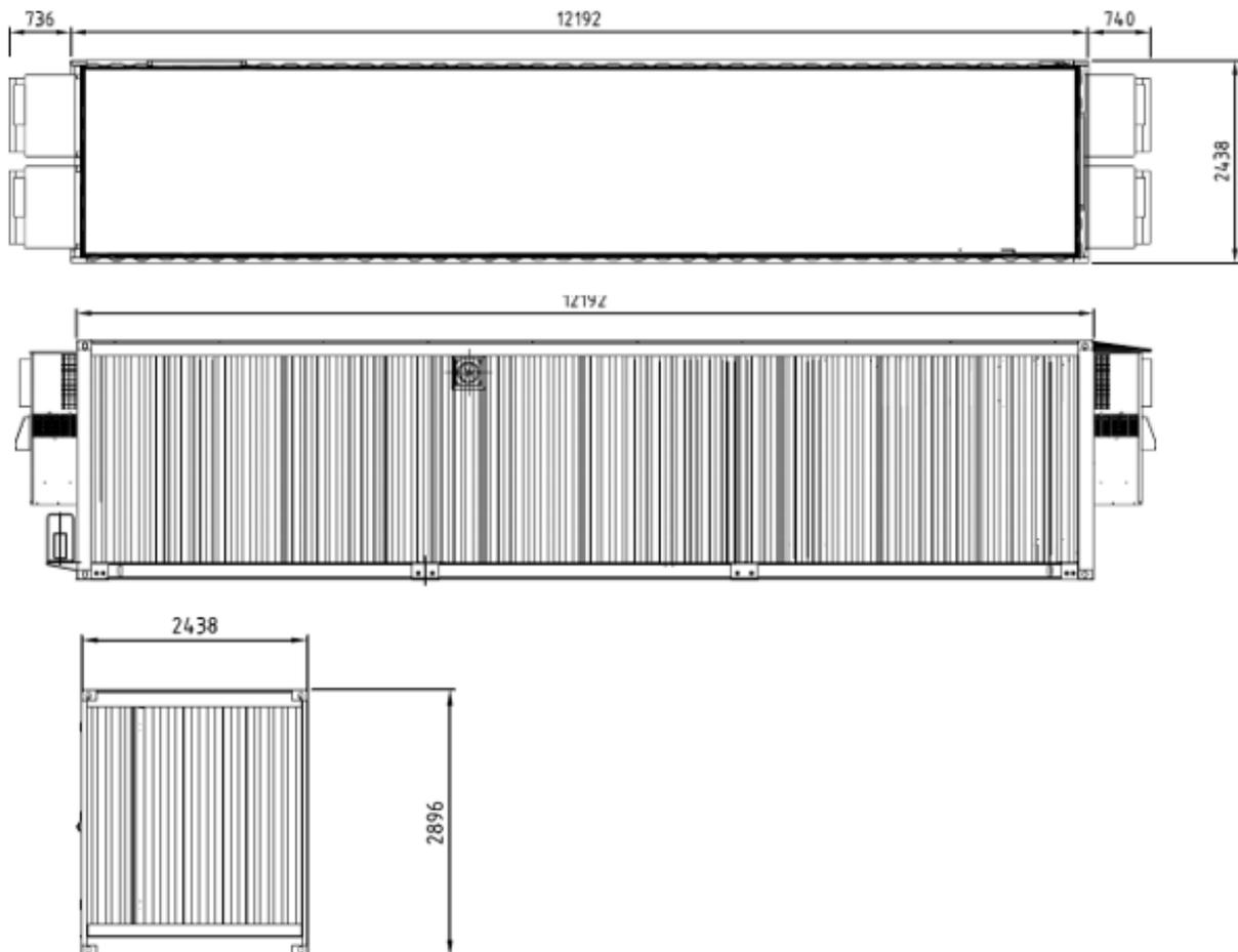
Figura 20: Modulo Container Batterie
