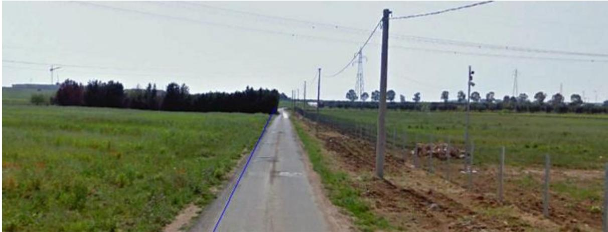
**Figura 18:** Tratto di strada comunale "Avetrana". Il cavidotto esterno MT, in uscita dalla cabina di raccolta, sarà posato lungo il margine di tale strada.
