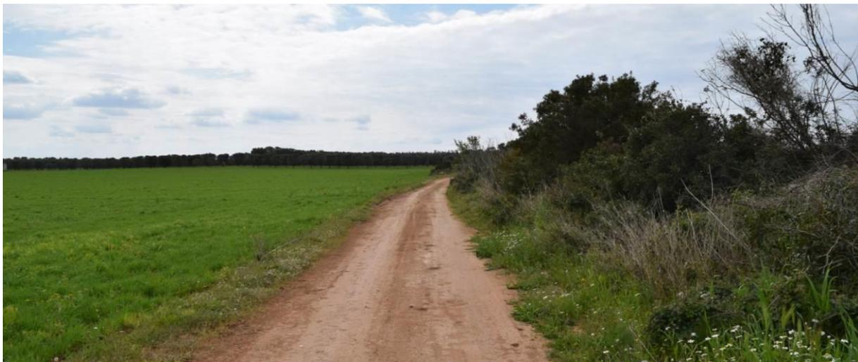
**Figura 18: stradina di accesso all'aerogeneratore A07, tratto in partenza dalla SP 145. La stradina ha necessità di essere allargata per consentire il passaggio dei mezzi di trasporto eccezionali.**
