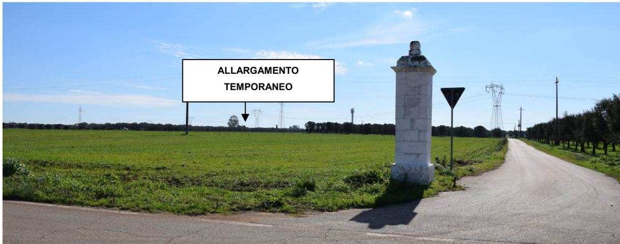
**Figura 29 - Incrocio tra SP107 e strada di accesso all'aerogeneratore A01, che necessita di allargamento temporaneo.**
