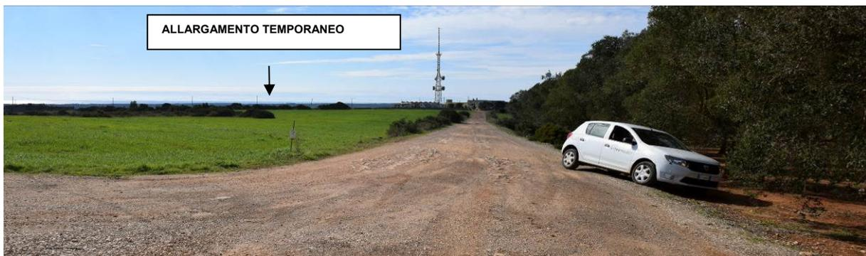
**Figura 30 – Imbocco della strada di accesso all'aerogeneratore A03 che necessita di un allargamento temporaneo sulla sinistra e dell'abbattimento di pochi alberi sulla destra.**
