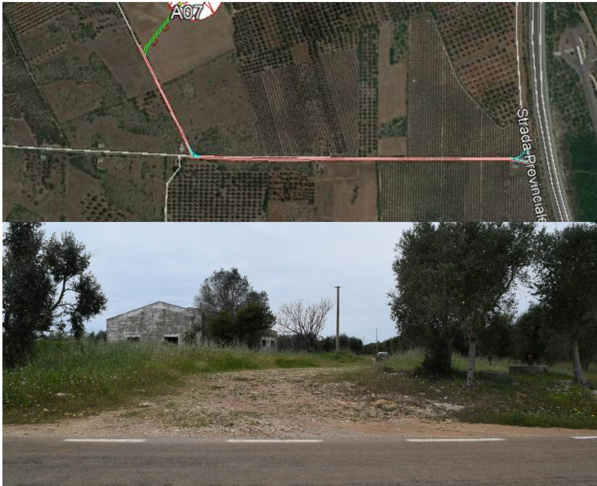
**Figura 34 – Imbocco dalla SP219 della strada di accesso al sito di ubicazione dell'aerogeneratore A07 che necessita di allargamento temporaneo.**
