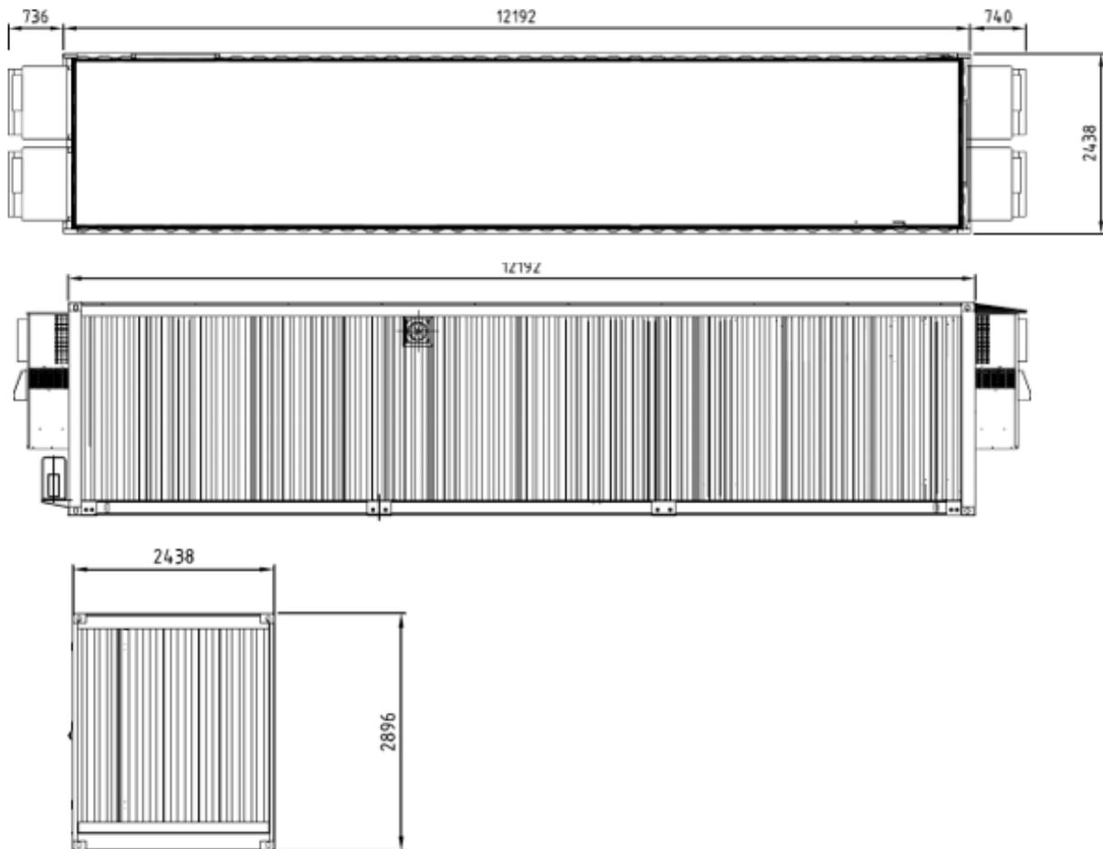
**Figura 45: Modulo Container Batterie**
