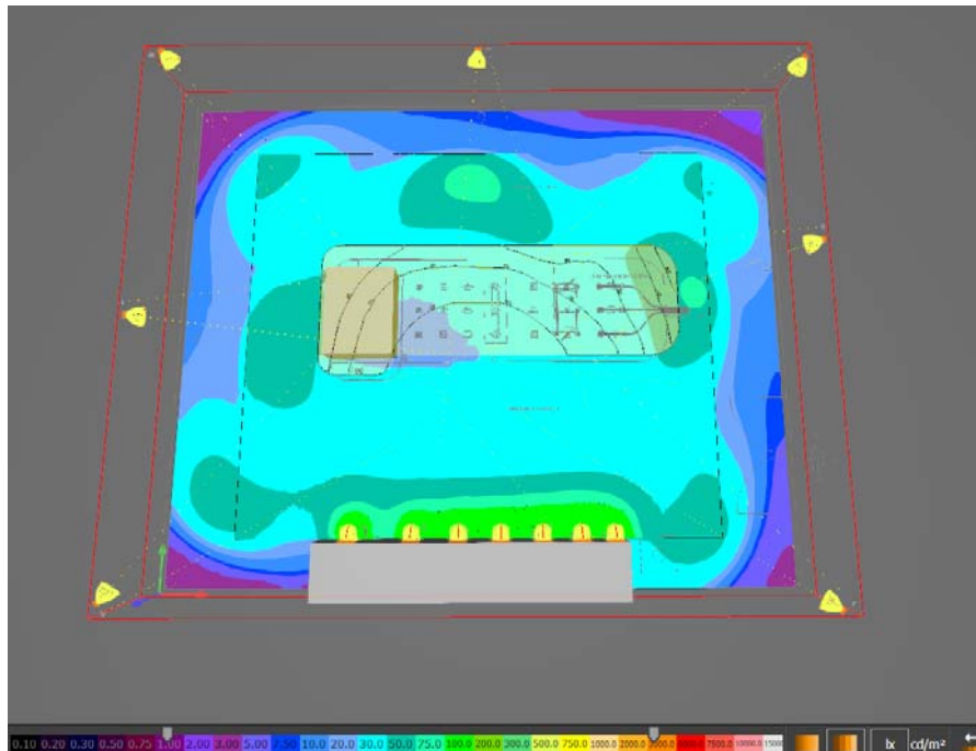
Figura 4: Colori sfalsati / Scena luce: illuminamento ordinario I livello (20 LUX) / Illuminamento perpendicolare (adattivo).
