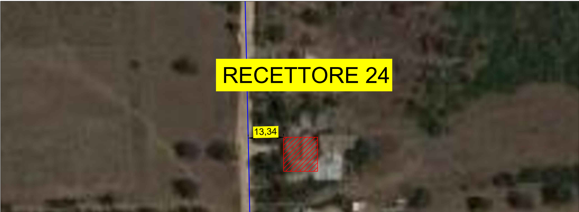
Figura 13 Verifica posizionamento e distanza di recettore sensibile rispetto dal cavidotto MT di progetto.
