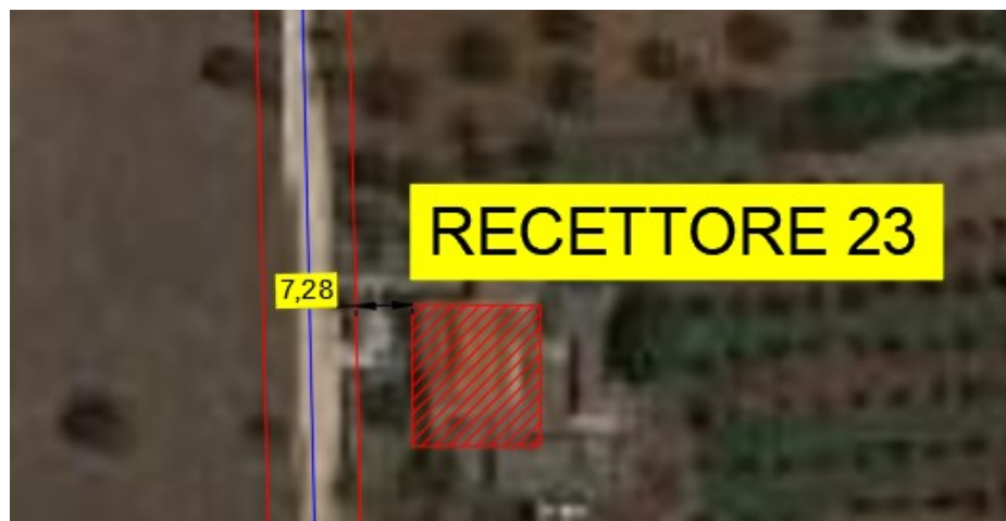
Figura 18 Verifica posizionamento recettore sensibile rispetto a una DPA del cavidotto considerata pari a 6 m
