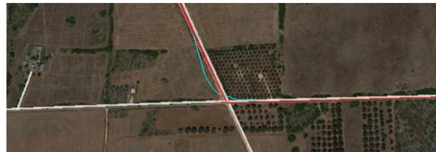
Figura 13 - Incrocio tra SP107 e strada di accesso all'aerogeneratore A01, che necessita di allargamento temporaneo.
