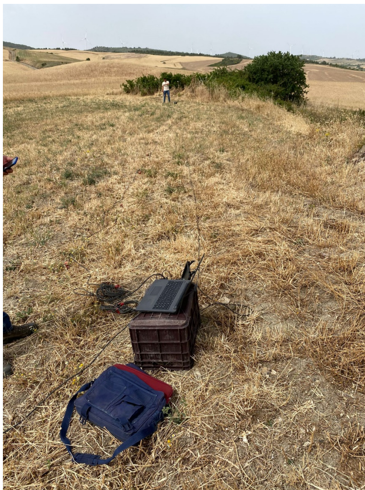
Postazione indagine sismica MASW M3
