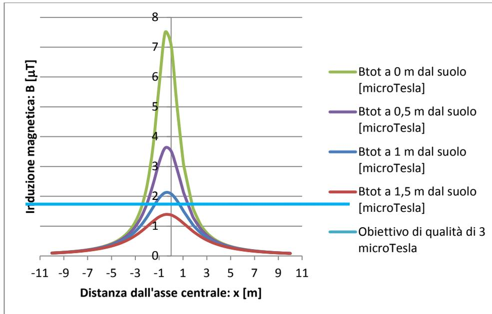
Figura 3: Andamento del campo magnetico generato dal cavidotto MT, composto da due terne una da 400 e una da 400 mm<sup>2</sup>
