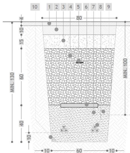
Figura 2: Sezione tipo cavidotto MT composta da due terne una da 400 e una da 630 mm<sup>2</sup>
