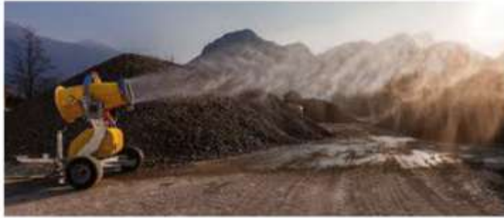
Impianto di nebulizzazione
