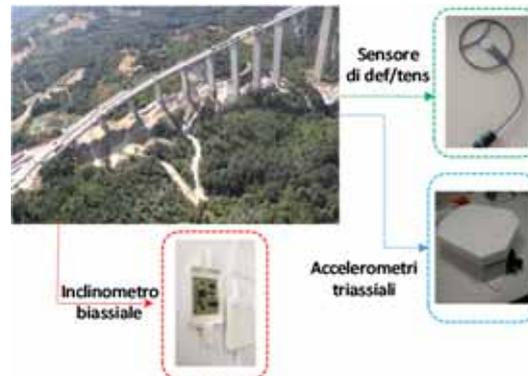
Figura 23. Sensori a tecnologia MEMS utilizzati per il monitoraggio
