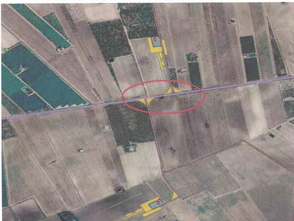
Intersezione viabilità relativa agli aerogeneratori 1, 2 e 3 con la SP 110 (allargamenti incroci per consentire la corretta manovra dei trasporti eccezionali).
