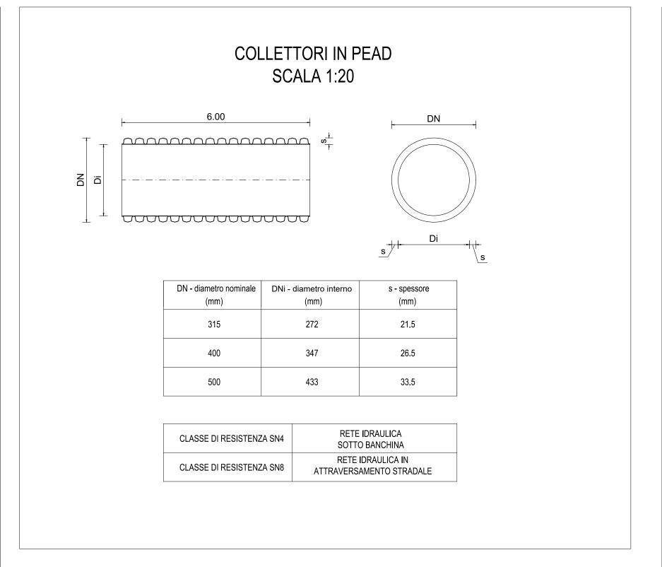
SEZIONE TIPO DI POSA COLLETTORE
