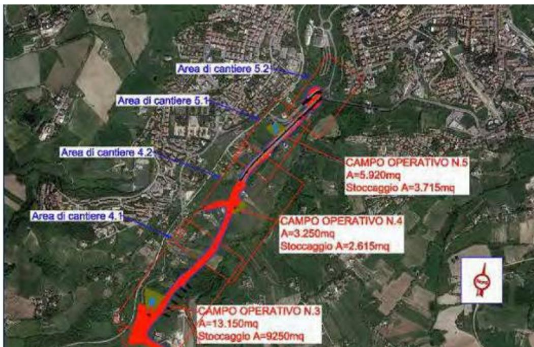
I cantieri operativi sono stati dislocati per la gestione puntuale delle aree di stoccaggio dei materiali e il parcheggio temporaneo dei mezzi di cantiere: in corrispondenza dei cantieri verranno allestiti tre campi operativi la cui superficie e la corrispondente area di stoccaggio viene riportata nella seguente tabella (i campi operativi in verde sono relativi al Tratto 2).
