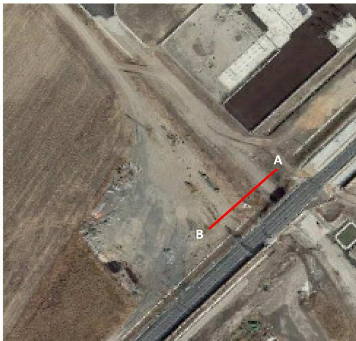
Figura 4 – Posizione dello stendimento geofonico per l'indagine MASW.
