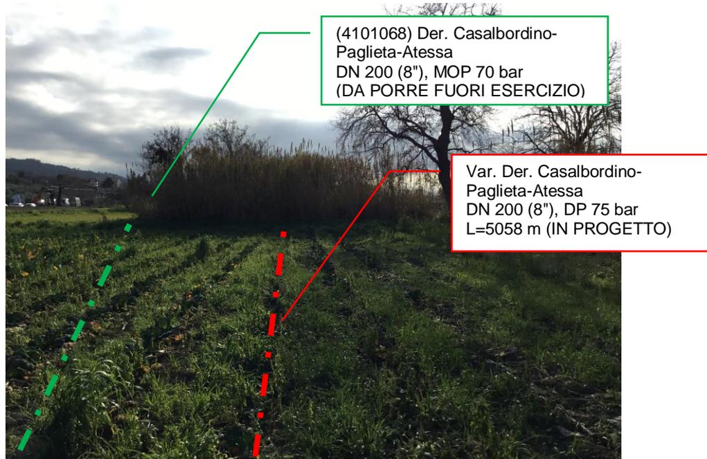
Foto n.3 – Vista metanodotto in progetto e metanodotto da porre fuori esercizio
