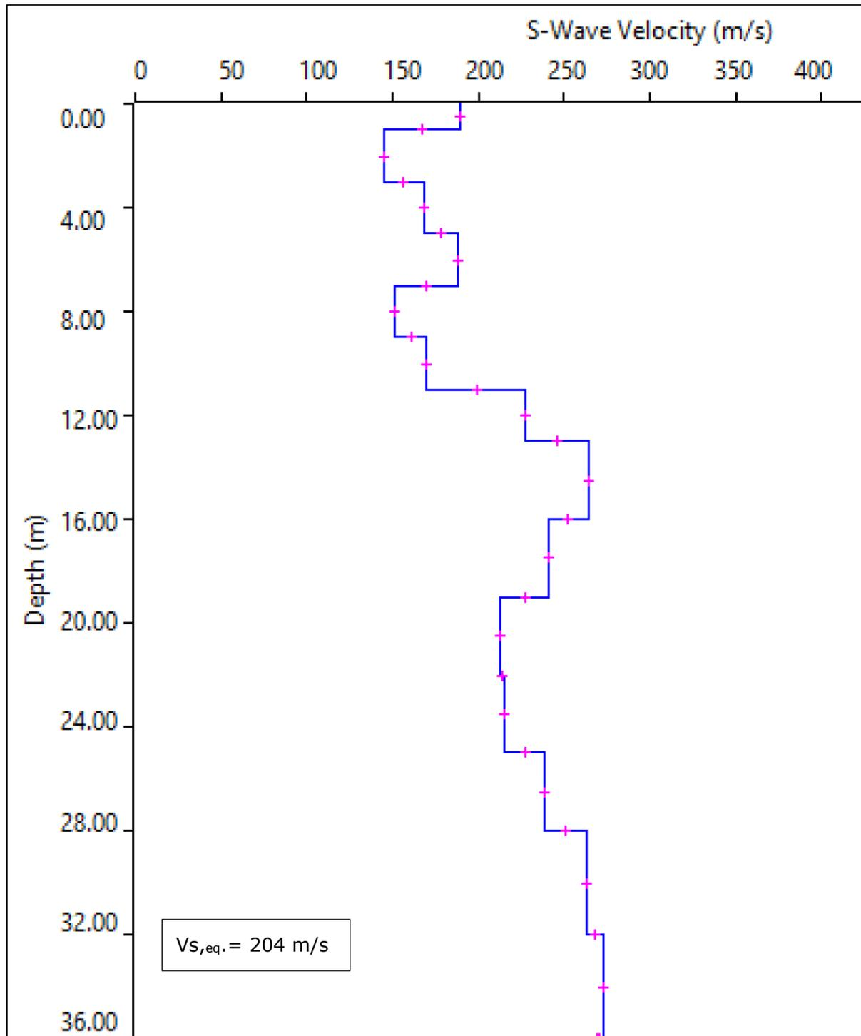
**Figura 6.1.2** – Vs misurate dalla prova MASW 2
