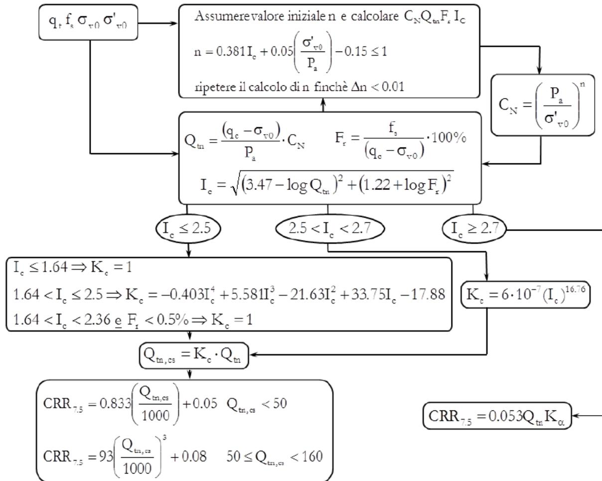
**Figura 6.5.1** - Schema di calcolo di CRR, mediante prove CPT/CPTU, secondo Robertson 2009
