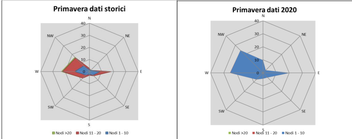
Figura 7-6 Confronto dati anemometrici stagione primaverile (Fonte: Elaborazione dati Aeronautica militare – Stazione Amendola)
