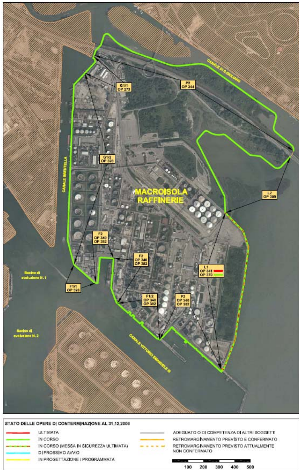
Figura 1-8: Opere di marginamento in esecuzione presso la Macroisola di Raffineria
