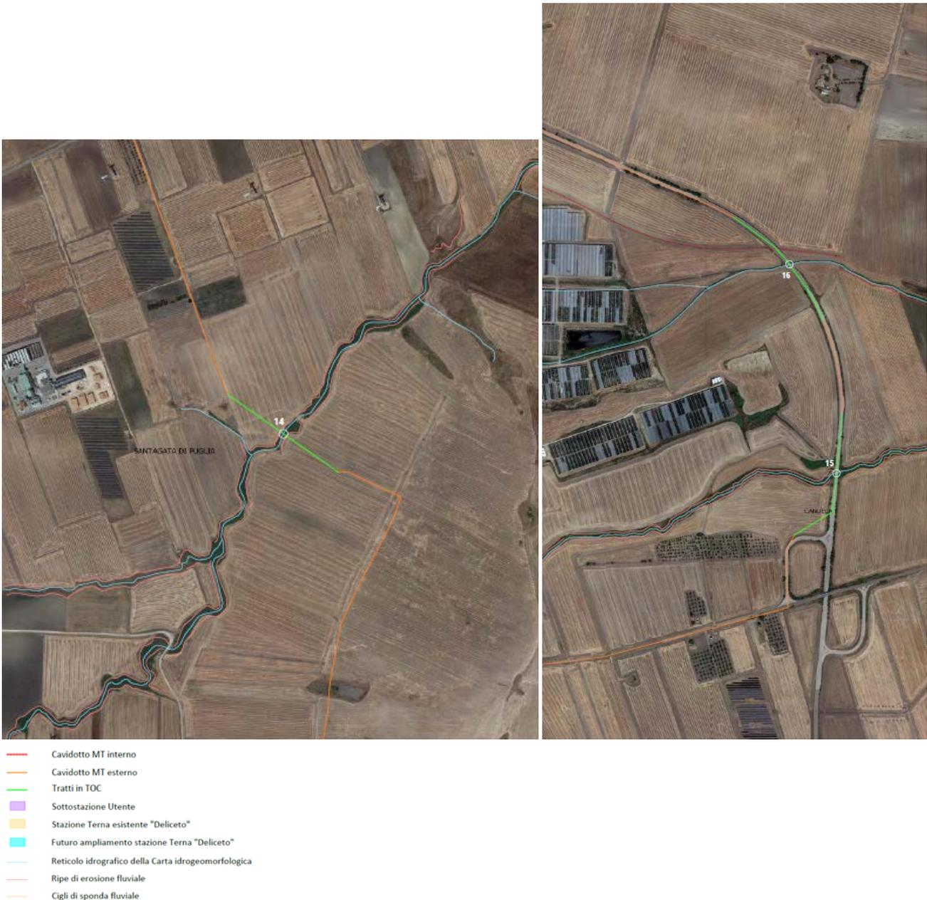
*Planimetrie delle intersezioni del tracciato del cavidotto con il reticolo idrografico*
