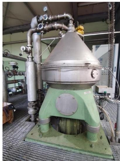
*Figura 31: modello tipo separatore centrifugo*
