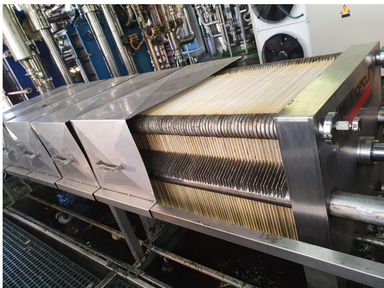
*Figura 33: modello tipo filtro a cartoni*
