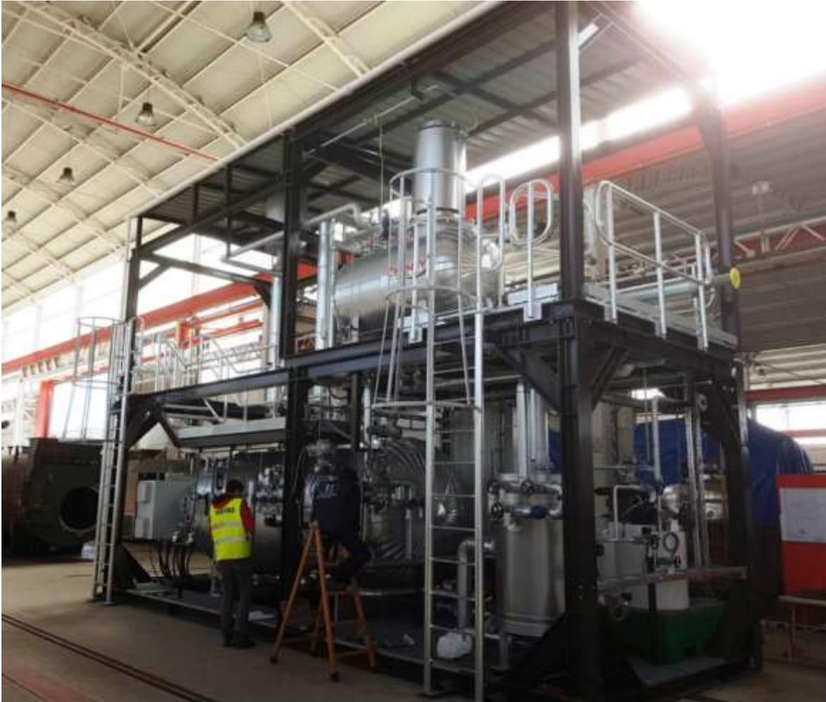
*Figura 4-1: Caldaia ausiliaria elettrica*
