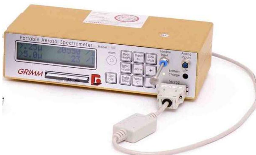
Fig.7. Esempio di strumento contaparticelle.
