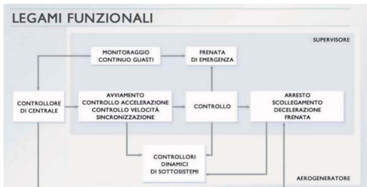
Figura 9: schema di controllo dell'aerogeneratore
