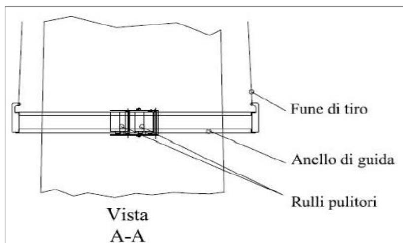
Figura 10: Illustrazione funzionamento dei rulli pulitori
