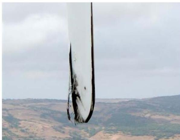
Figura 13 estremità di pala danneggiata da fulminazione atmosferica
