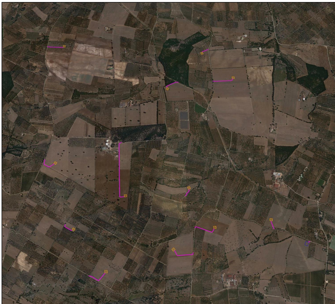
Figura 14: Fase di esercizio: viabilità e piazzole
