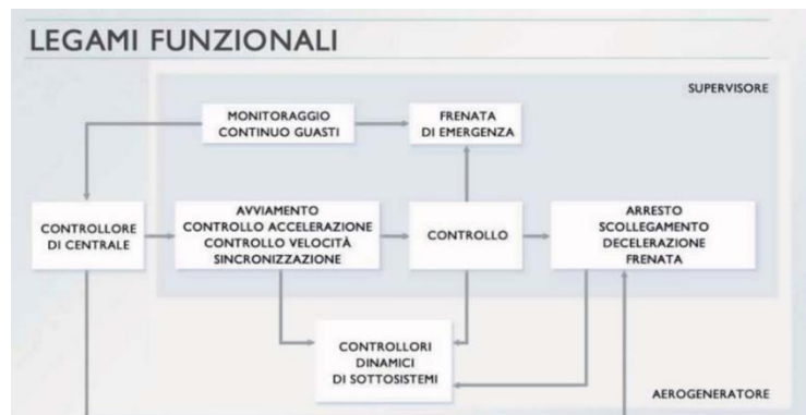
FIGURA 22: SCHEMA DI CONTROLLO DELL'AEROGENERATORE
