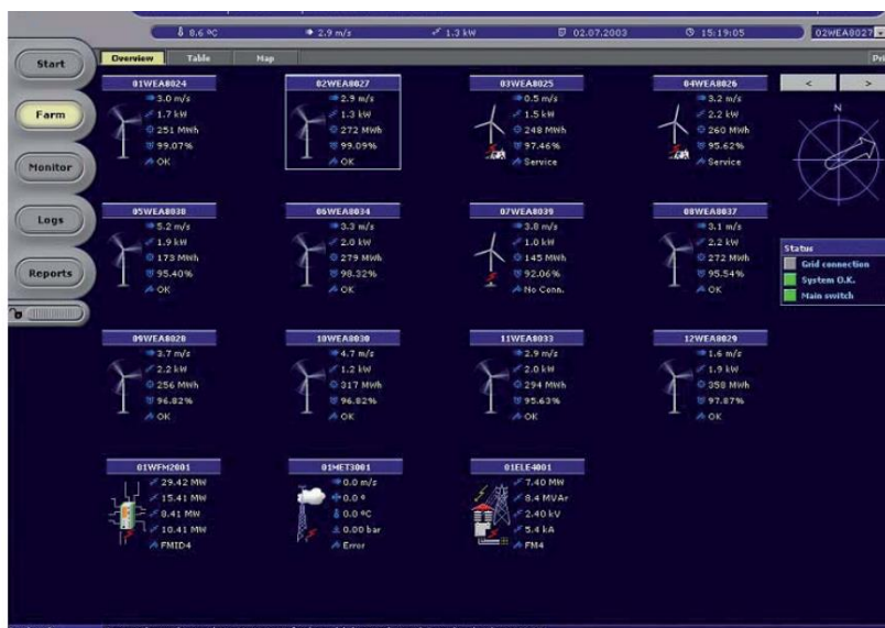
FIGURA 21: MONITORAGGIO REMOTO DI UNA WIND FARM
