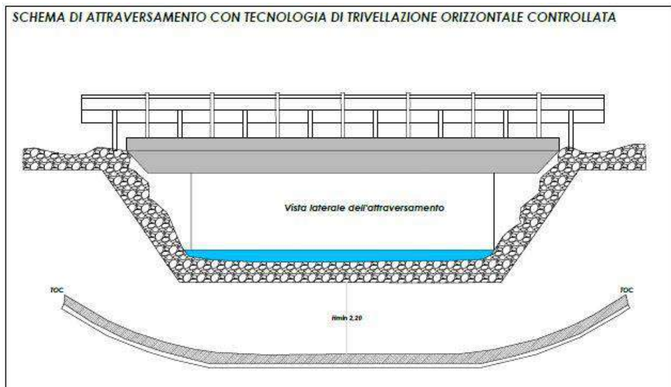
Figura 31: schema di attraversamento con TOC
