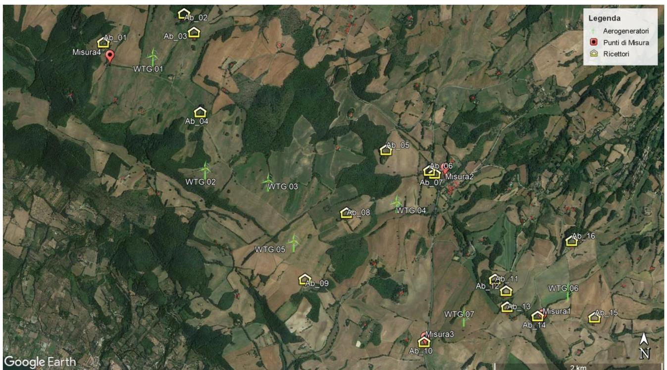
Figura 4 – Aerofoto con posizione aerogeneratori, ricettori e punti di misura
